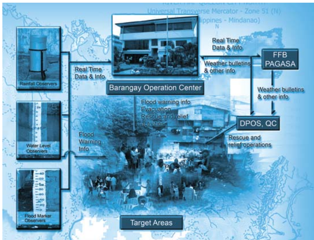
Quezon City's barangay flood warning system (Lansang).
